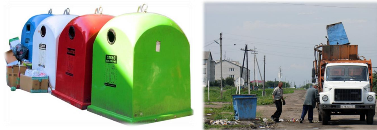
Рисунок 1 – Контейнерні системи «змінюваних» і «незмінюваних» збірників
